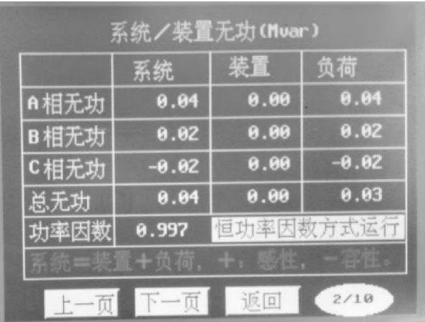
图 9 双向变流 1.5 倍过负荷补偿 SVG 数据显示 Fig. 9 SVG data display at 1.5 times overload compensation of bidirectional converter
