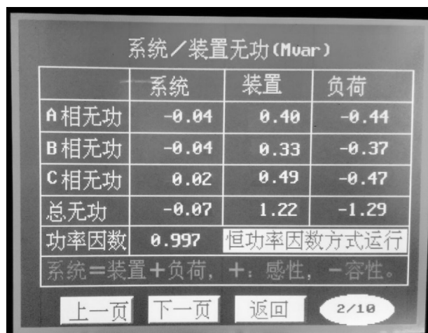
图6 双向变流装置补偿功能未投入时SVG数据显示 Fig. 6 SVG data display without operation of bidirectional converter compensation function
